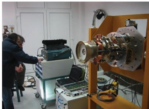
Receptor tribanda em fase final de montagem
